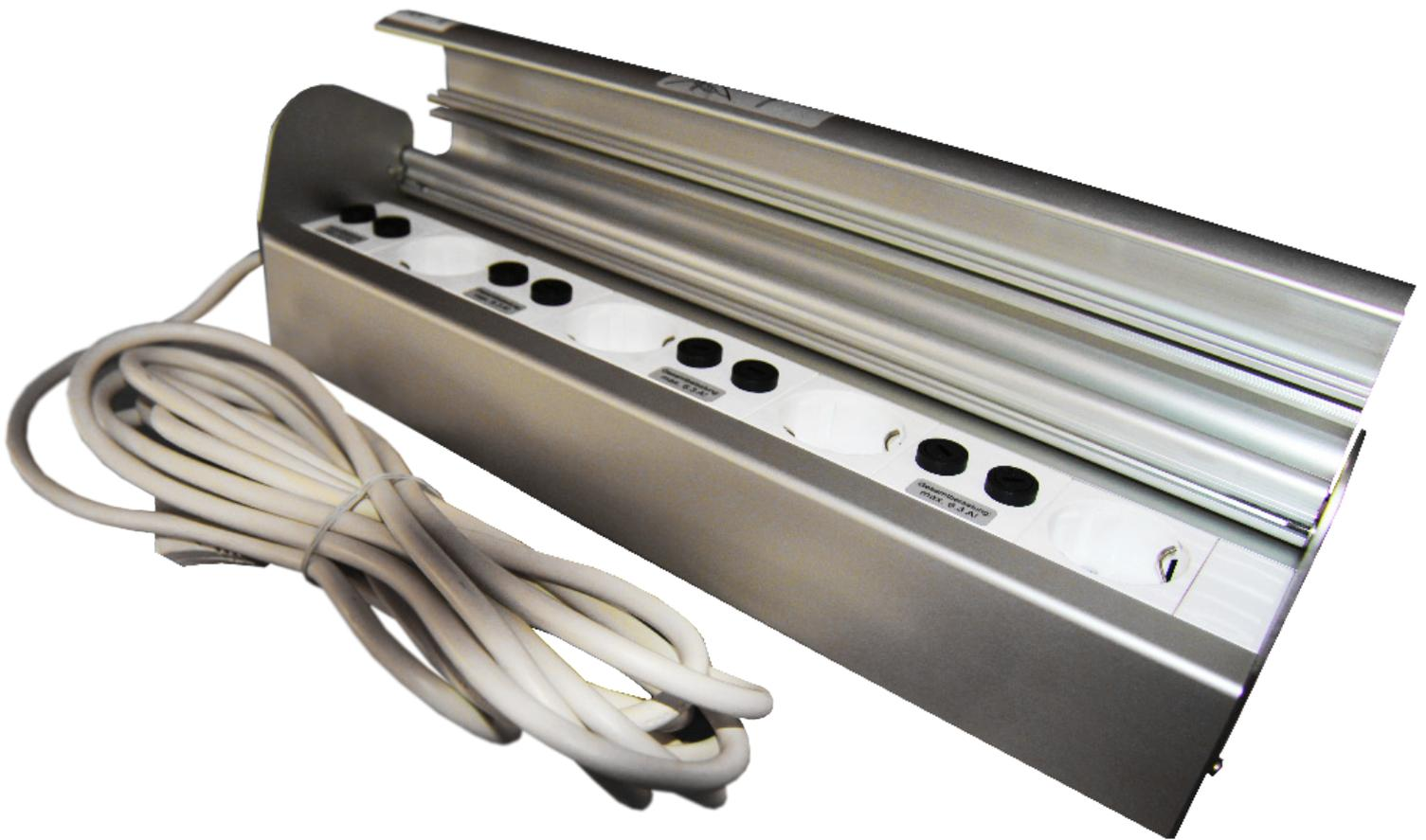
Unsere Mehrfachsteckdosen bestehen aus einem robusten, natureloxierten Aluminiumgehäuse mit einem klappbaren, bruchfesten Aluminiumprofil als Auszugsschutz. Dieser rastet fest ein und kann nur mit einem Werkzeug geöffnet werden.
